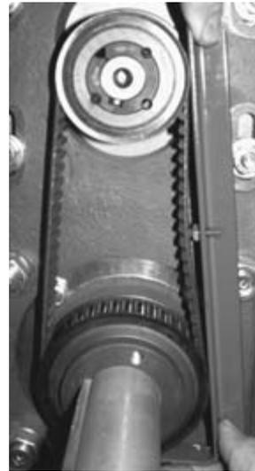
1. Die Befestigungsschrauben der Vakuumpumpe lösen.
