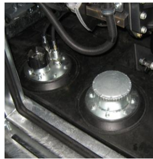
Kraftstofftank Korrosionsfreier 300 Liter Kraftstofftank aus HDPE, im unteren Teil des Schallschutzkastens geschützt positioniert.
