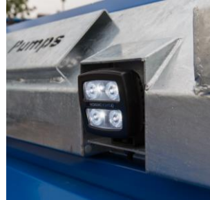
LED-Leuchten Vollständig in den Schallschutzkasten integriert, um den Betrieb am Abend und in der Nacht zu erleichtern.
