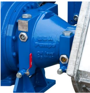
Einfache Wartung Ölstandsgläser, Ölablaßventile und Öleinfüllschrauben sind einfach zugänglich.
