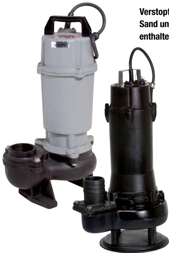
Gut ausgewuchtetes Semi-Vortex-Laufrad erzeugt Wirbelwirkung zur Abführung weicher oder faseriger Partikel, ohne dass es zum Verstopfen kommt. Freier Durchgang 32 - 65 mm (je nach Typ).
